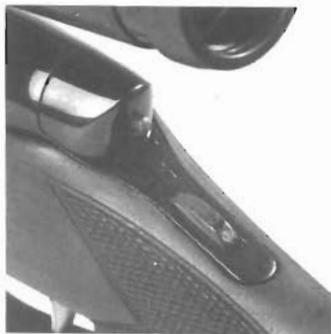
Stellung des Drehschiebers entsichert (roter Punkt ist sichtbar)
