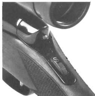
Stellung des Drehschiebers gesichert (S ist sichtbar)
